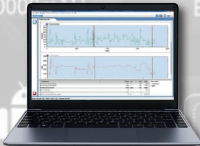
Con la funzione Flight recorder, puoi facilmente registrare i diversi parametri del tuo CDP+ da uno dei sistemi di controllo del veicolo durante la guida. Può essere di grande aiuto nell'individuare errori legati a velocità, superficie stradale irregolare, problemi tecnici e altro. Al ritorno, è possibile caricare le informazioni registrate sul software, valutare e analizzare i dati registrati a proprio piacimento.
